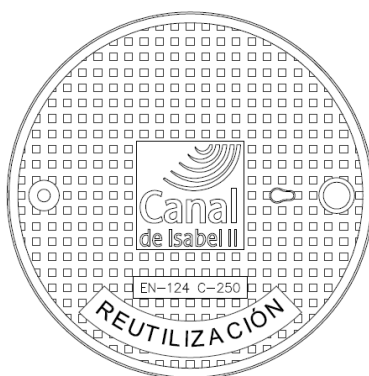
Fig 9. Arqueta integral en acometida de agua regenerada
