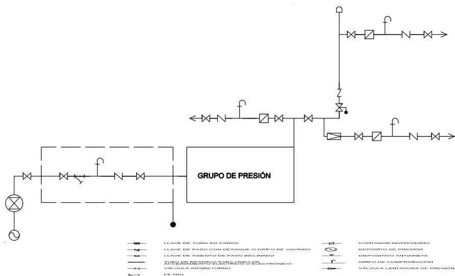
Figura 3.2 Esquema de red con contadores aislados
