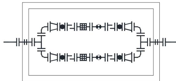
Figura 38. Instalación de válvulas reductoras de presión. Disposición en paralelo
