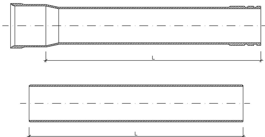
Figura 14. Dimensiones en los tubos de PRFV (tubos con embocadura o lisos)
