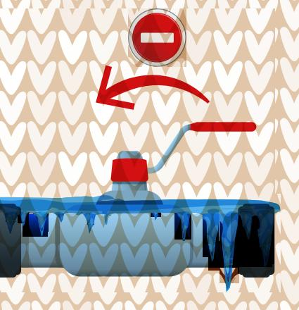
Aplica calor a la instalación con un secador u otra herramienta, pero nunca con fuego de forma directa.
